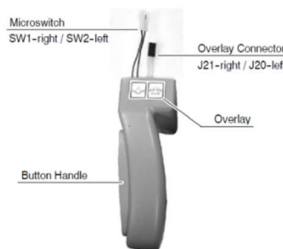
Figura 1 Microcomutatorul și conectorii suprapuși ai mânerului
